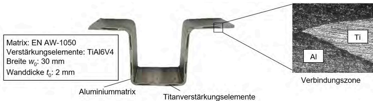
Abbildung 6: Hutförmiges Profil aus Aluminium-Titan-Hybridblech
