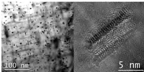
Abbildung 2: TEM-Aufnahme einer mittels Blockcopolymerlithographie nanostrukturierten Polystyrol(PS)-Schicht
